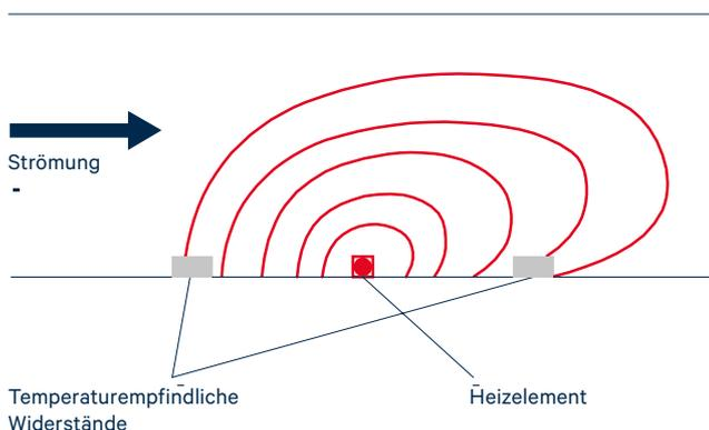
**Bild 1** Prinzip der thermischen Massendurchflussmessung
