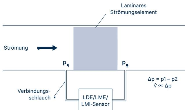
**Bild 4** Typische Anordnung zur Volumenstrommessung mit Differenzdrucksensor
