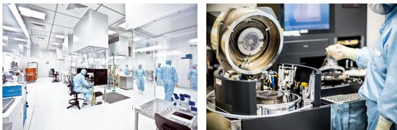
Am Hauptsitz der First Sensor AG in Berlin-Oberschöneweide entstehen in der Halbleiterproduktion unter Reinraumbedingungen Sensorchips für optische Sensoren und MEMS-Drucksensoren.
